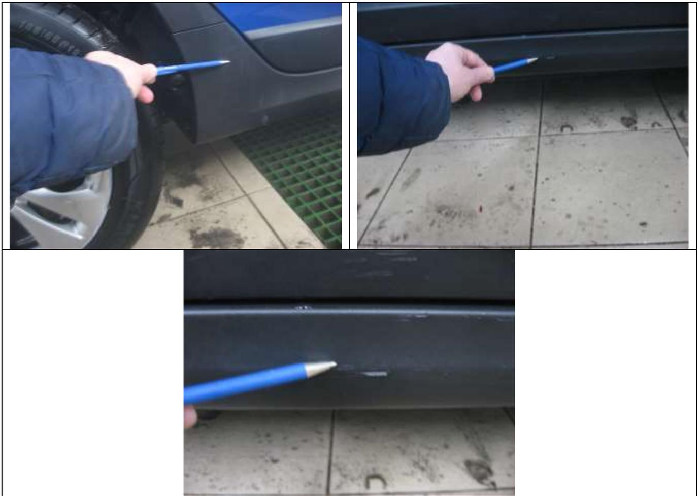
На нижней кромке правой верхней боковины имеются деформации ЛКП в виде шероховатостей необработанной после нанесения ЛКП (см. фото ниже, CD-диск).
