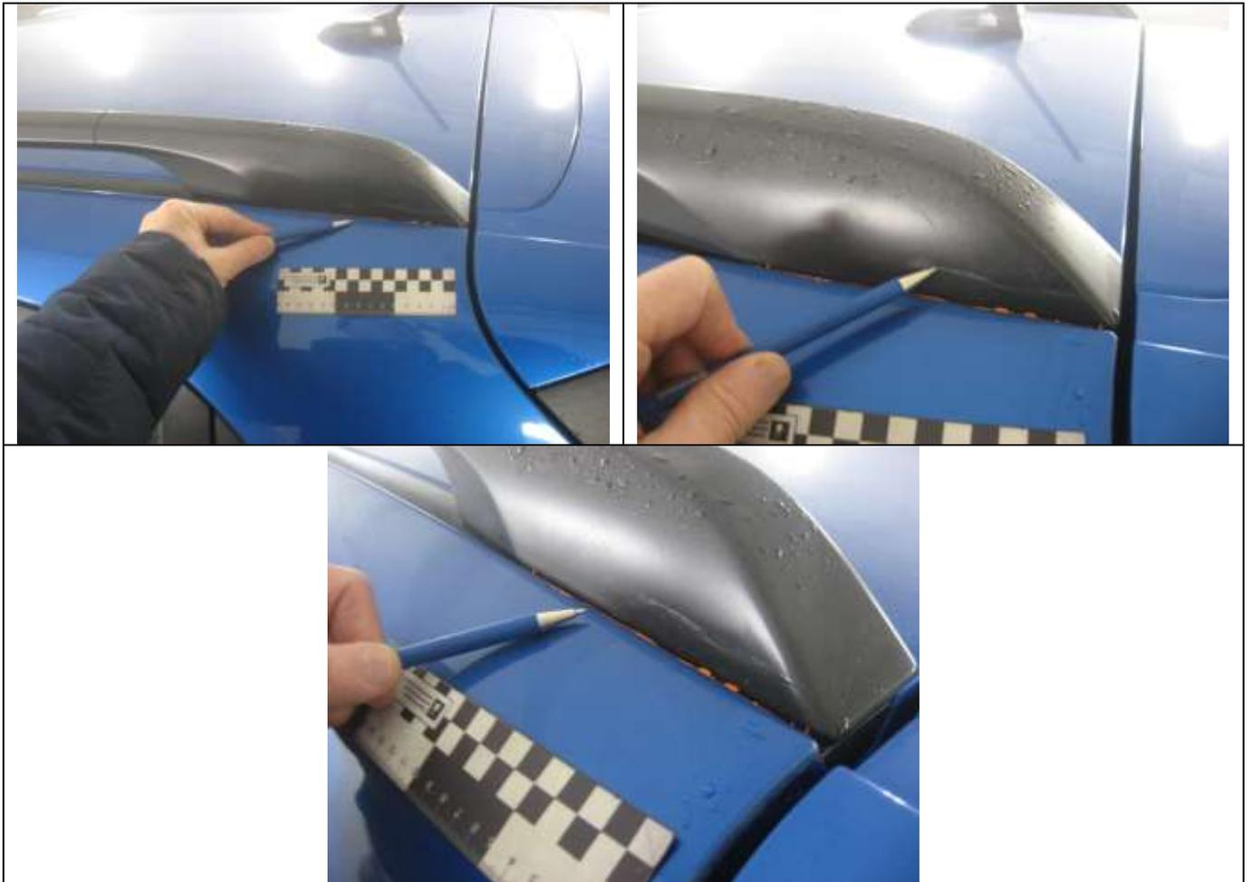
Уплотнитель ветрового стекла имеет повреждения – разрывы, царапины, (см. фото ниже, CD-диск).
