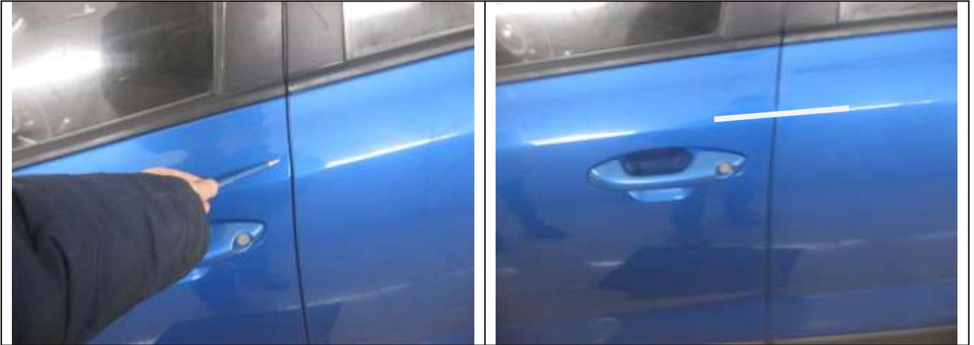
Установлен перекосяк левых дверей (см. фото ниже, CD-диск).
