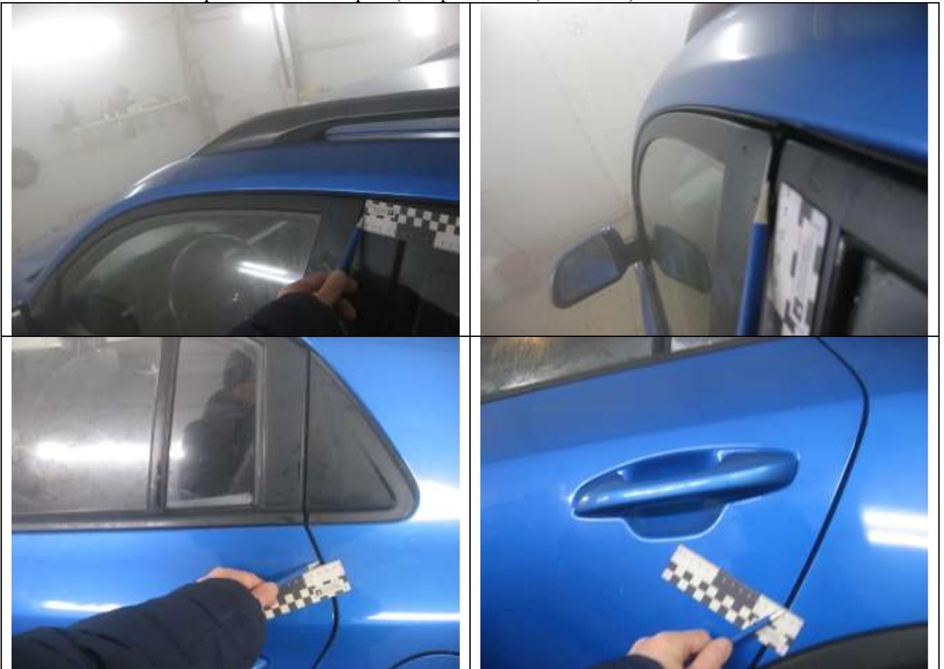
У задней части левого реслинга крыши присутствуют технические следы работ по окраске – не снятая защитная малярная лента. (см. фото ниже, CD-диск). Релинг (левый) в задней части, имеет повреждения фактуры материала, царапины.
